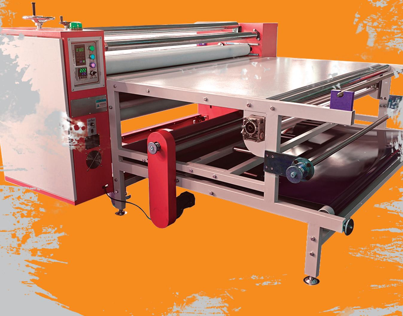
دستگاههای صنعتی کلندر حرارتی سری C18xx چلنجر در سایز استاندارد دهن 180 سانتی متری با خرچه 175 سانتی مترا تولید میشود که مطابق با استاندارهای جهانی صنعت نساجی میباشد، سری C18xx کلندر های چلنجر با سیلندرهایی به قطر 42، 60 و 80 سانتی متری عرضه میگردد که شما مشتریان گرامی با توجه نوع فرآیند کاری خود میتوانید بهترین انتخاب را داشته باشید.
